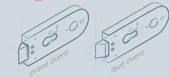
**Tichá streľka** - Streľky zámkov zo série **CT – 6000** sú vyrobené zo špeciálneho plastu pre tiché a komfortné zatváranie dverí pri kontakte s protiplechom zárubne.
