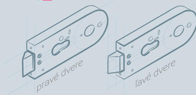
**Tichá streľka** - Streľky zámkov zo série **CT - 11000** sú vyrobené zo špeciálneho plastu pre tiché a komfortné zatváranie dverí pri kontakte s protiplechom zárubne.
